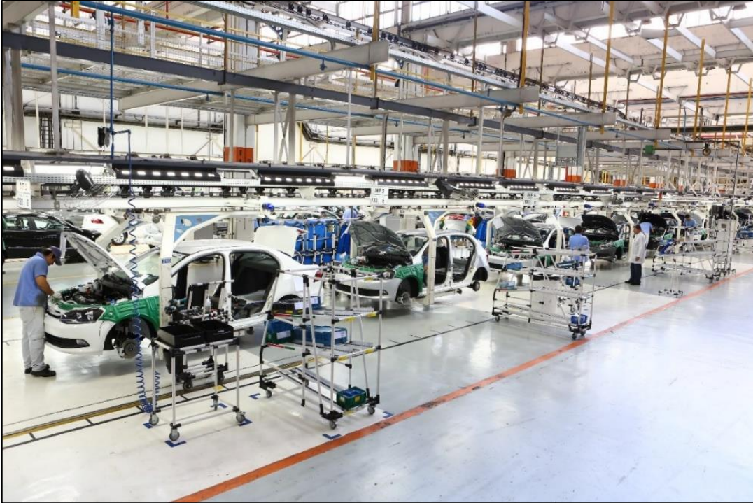
Figura 2 - Exemplo de arranjo físico linear na indústria automobilística.
