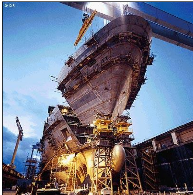
Figura 3 - Exemplo de arranjo físico posicional na indústria naval.
