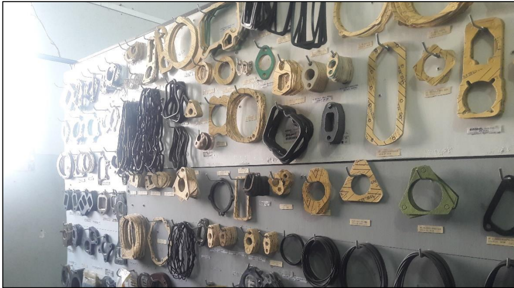
Figura 15 - Quadro de juntas pendurado na divisória
