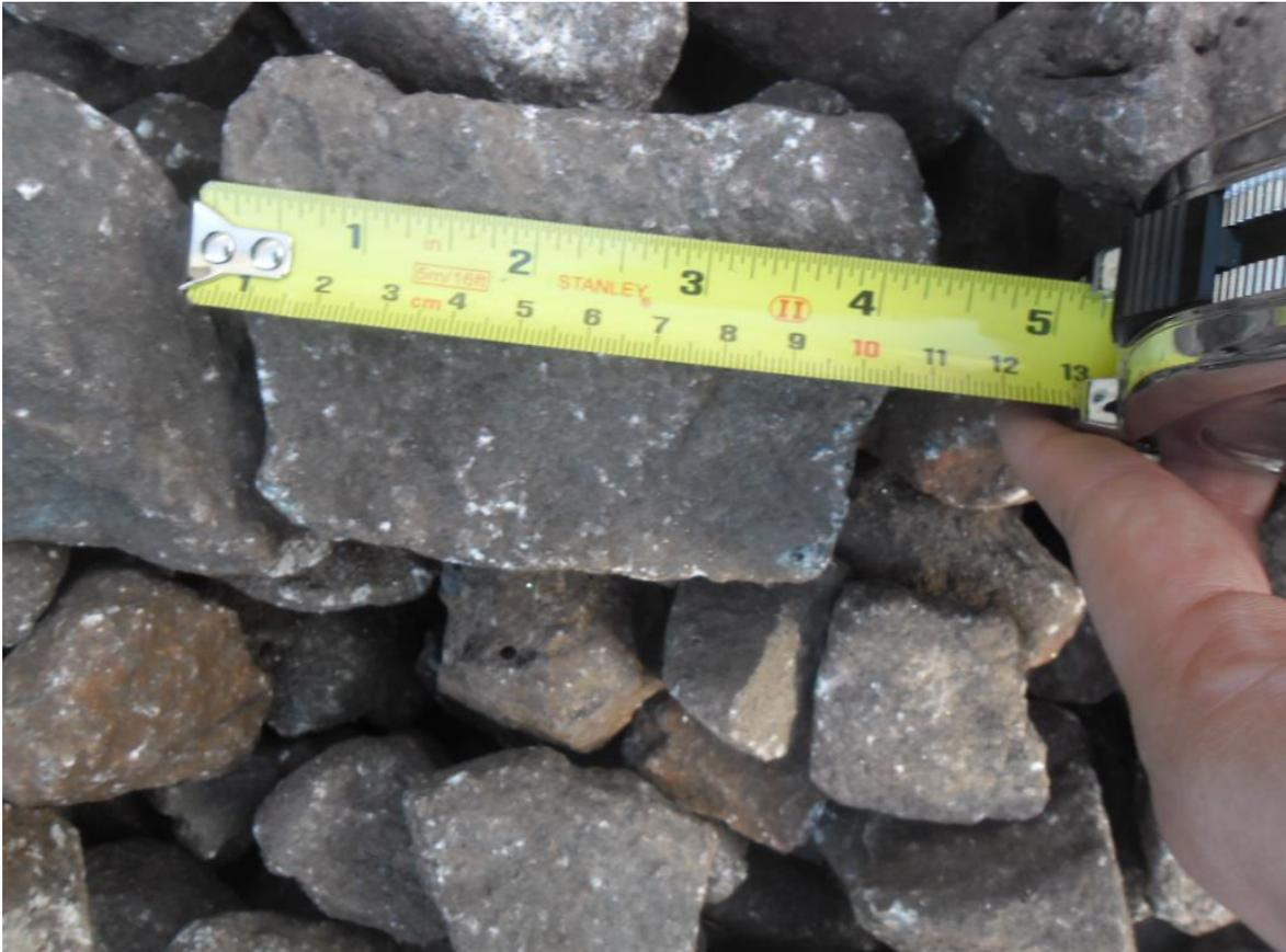
**Figura 11: Medição do Lastro**
