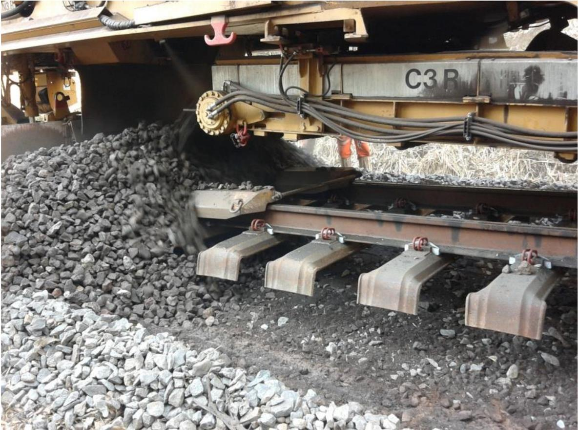
**Figura 5: Máquina Desguarnecedora Trabalhando na EFVM**
