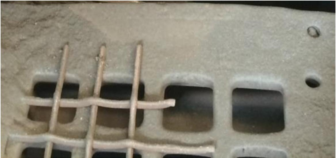
**Figura 14: Imagem da Peneira com Falha**
