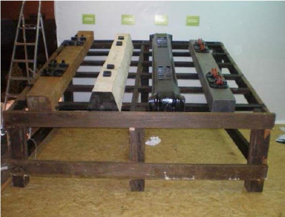
**Figura 3: Da esquerda para a Direita: Dormente de Madeira, Concreto, Aço e Plástico**
