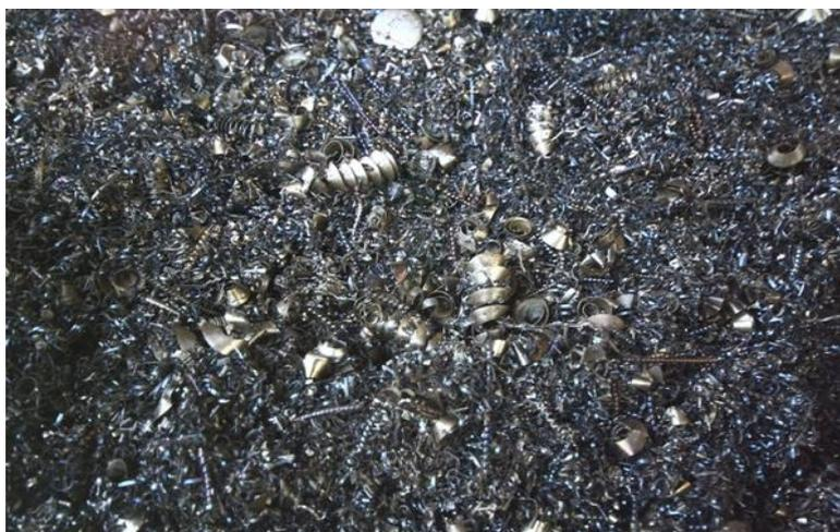
**Figura 13: Cavaco de usinagem coletado em tambor**
