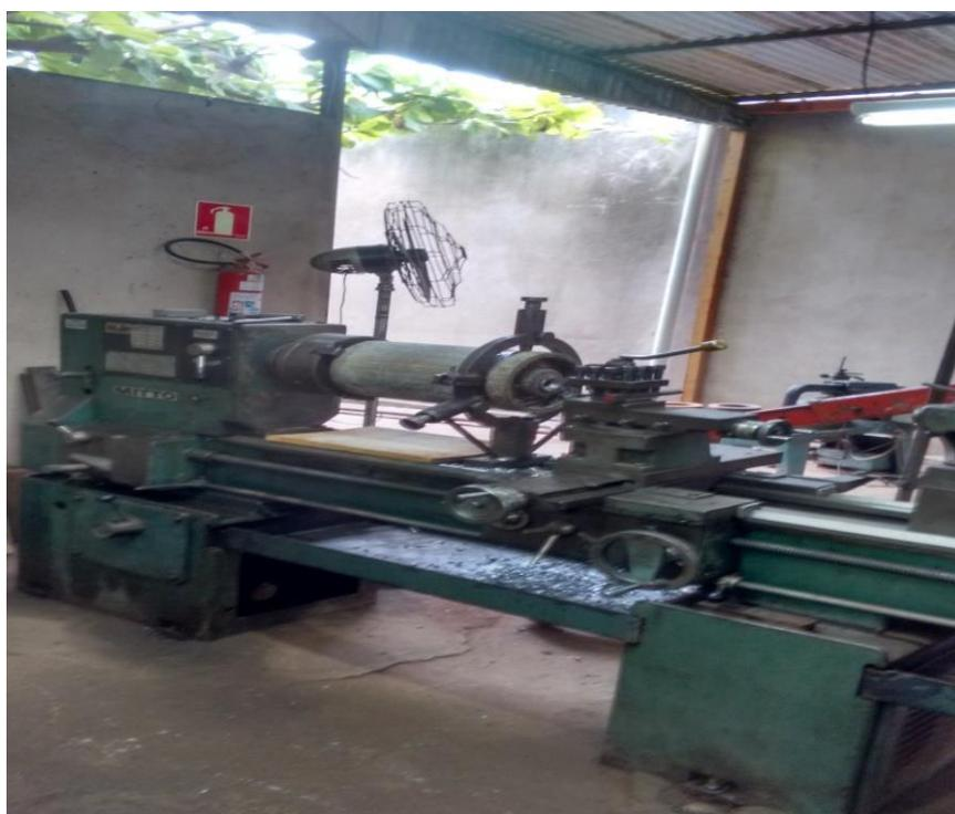
**Figura 10: Torno mecânico**
